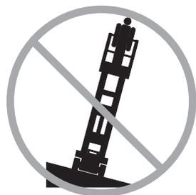
请勿把倾斜警报器当成水平指示器。只有机器严重倾斜时，底盘上的倾斜警报器才会鸣响。
