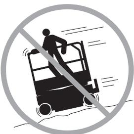
根据地面状况、拥塞程度、坡度、人员位置和可能引起碰撞的任何其它因素，限制行进速度。
