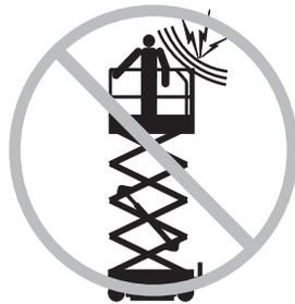
如果机器接触到带电的电线，请远离机器。切断电源前，禁止地面或平台上的人员触摸或操作机器。
