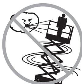
请勿在强风或阵风时操作机器。请勿增加平台或负载的表面面积。加大暴露在风中的面积将降低机器的稳定性。
